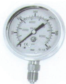
Manometru D63 radial, INOX, cu glicerină, filet 1/4" clasa 1.6
