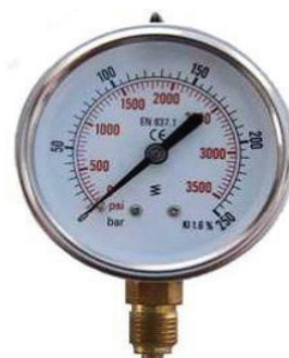
Manometru D100 radial, INOX, cu glicerină, filet 1/2" clasa 1.6
