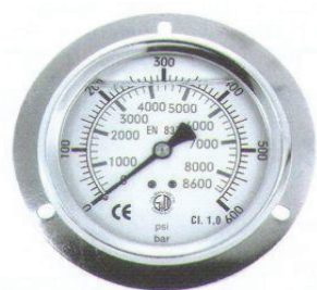
Manometru D63 axial, INOX, cu glicerină, filet 1/4", fixare prin flanșă
